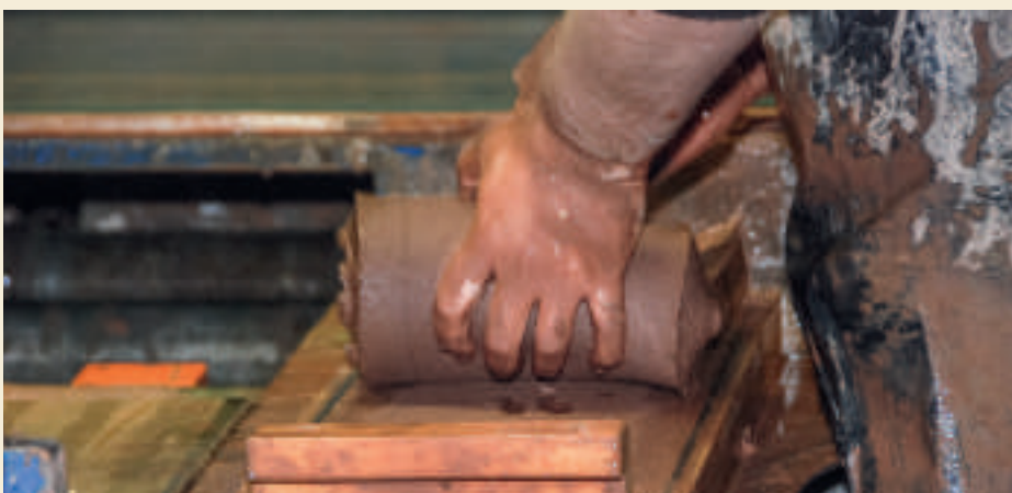
En lerklump hældes i en våd form. Leret trykkes ud, og det overskydende materiale stryges af. Når håndstrygeren hæver formen, glider den formede lerklump, med vand som glidemiddel, fri og efterlades på en plade.
